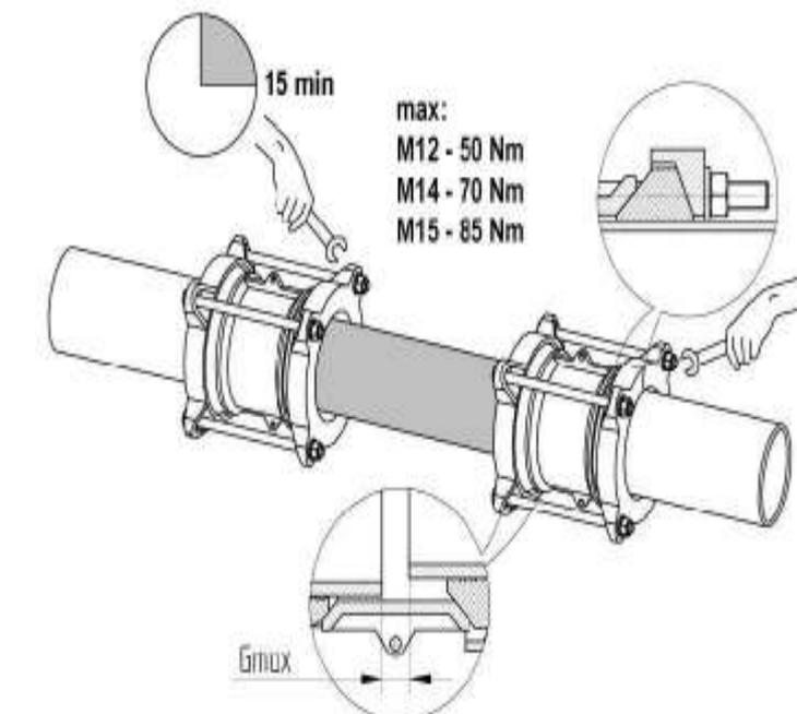
Вставить новый отрезок трубы и надвинуть на ее концы соединительные муфты.
