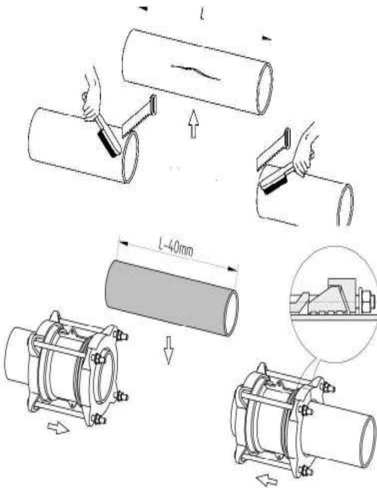
Перед установкой проверить наружный диаметр трубы, а также подобрать соответствующее соединение. Очистить концы труб от ржавчины и других загрязнений по всей длине всовывания.
